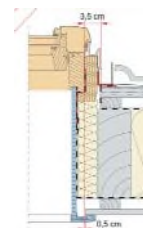
9. ábra. A hőszigetelő keret által biztosított szélesség
