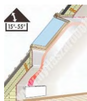
3. ábra. A tetősíkablak fülkéjének átöblítése a gyártói ajánlások szerint
