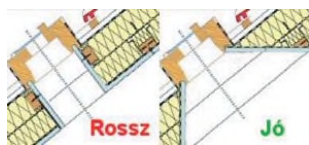
4. ábra. A beépítés geometriája a gyártói ajánlások szerint
