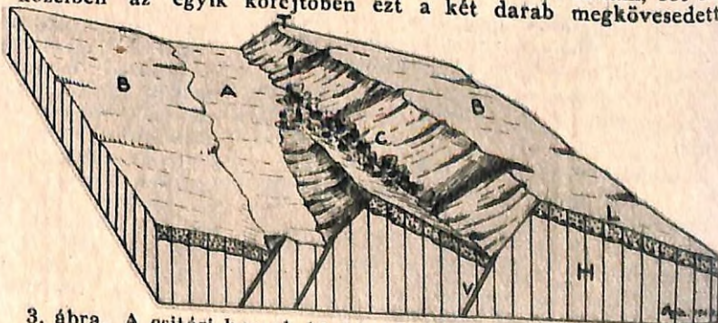
3. ábra. A csitári hegyek kialakulását szemléltető tömbszelvény. A — lesüllyedt lapályok. B — lankás lejtőjű dombhátak. C — Csitár község. H — homokkő, agyag. I — lösz. T — Tölgyfa-tető. V — törésvonal.
