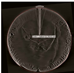
8. kép – CT metszeti kép – A pecsét átmérője közel 67 mm
