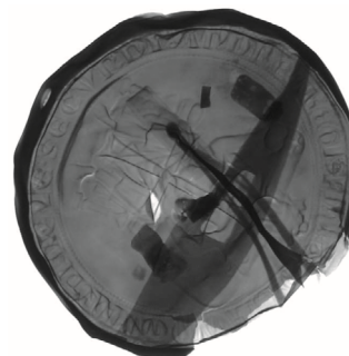
22. kép – A pecsét röntgenképe – A kereszt irányú merevítő nem a legnagyobb átmérőben, hanem annak kétharmad részénél helyezkedik el. Közepén egy négyszög alakú kivágás, ebben megy át a merevítésre merőleges irányú rögzítőszeg. Feltételezhető, hogy a merevítésnél utólagos javítás is történt – a bal oldali forrasztás egyenes vonalú, míg a bal oldali jelölt szegmensben nagyobb területen detektáltunk porozitást, apróbb lunkereket.
