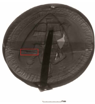
32. kép – A pecsét röntgenképe – Kereszt irányban egy merevítőt építettek be, amelyet a detektált lukak alapján forrasztással rögzítettek a pecsét egyik oldalához. Ezzel merőleges irányban egy zárólemez illeszkedik a pecséthez.
