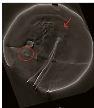
30. kép – CT metszeti kép – jelentős porozitás a merevítés rögzítési felületén
