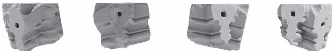
1. kép: Az 1. típusú boltozati bordacsomópont térszkennelt modelljének ortogonális nézetei
