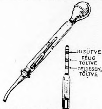
A fajsúlymérő a telep töltöttségi fokára enged következtetni.
