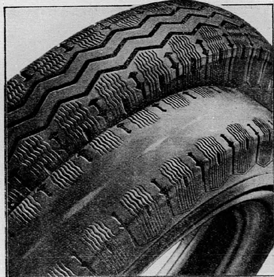
Új és majdnem teljesen elhasznált „Stop” pneu. Jól látni a féknyomat, hogy amíg a futófelület közepe már egészen simára kopott, a széleken még ép a lamella-rendszer.
