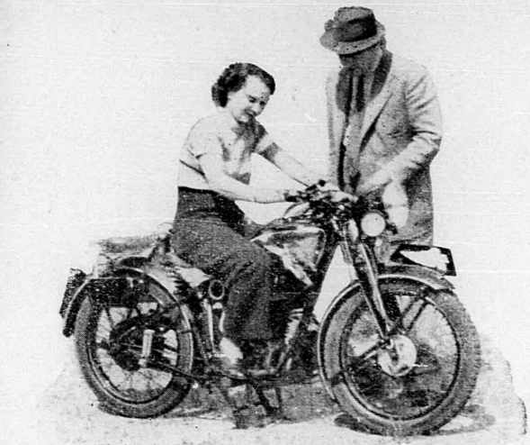
Szépén ismerkedjünk meg az összes szabályozószervekkel. Ez itt a kupplung, ez a gázasabályozó. Ezzel a karral működtetjük az elsőféket, ott lent jobbra a tartány mellett a sebességváltó gombja. Próbáljunk meg „szárazon” kapcsolgatni, gázt szabályozni, lassítani, gyorsítani, fékezni. Ugy-e, már otthonosan érzi magát a sok kar és szabályozó között?
