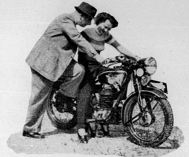
Most beindítom a motort a gép persze „stenderen” áll. A jobb oldali kormányzáron levő forgató markolattal (drégriff) szabályozom a motor fordulatszámát és ezzel a gép sebességét. Csak aztán eszünkön bánjunk a gázzal, nehogy a motor túlmelegedjék. És sohase adjunk hirtelen gázt, hanem csak fokozatosan csavarjuk a forgó markolatot.
