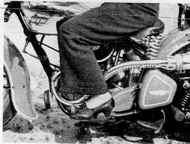
Igy kell a lábkapcsolásos géppel visszakapcsolni. Lábfejünk hegyével emeljük vissza a kapcsoló pedált. Minden egyes visszameléssel eggyel alacsonyabb fokozatot kapcsolunk.
