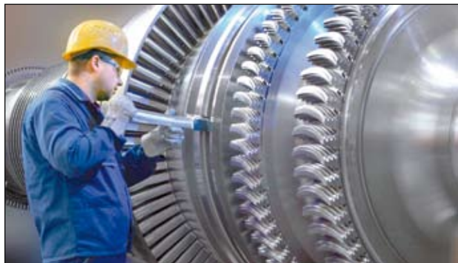
Turbinalapátok a német Siemens gyárból
