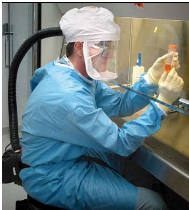
Ez a maszk folyamatosan túlnyomás alatt áll, a levegő csak a szűrőn át érkezik alá
