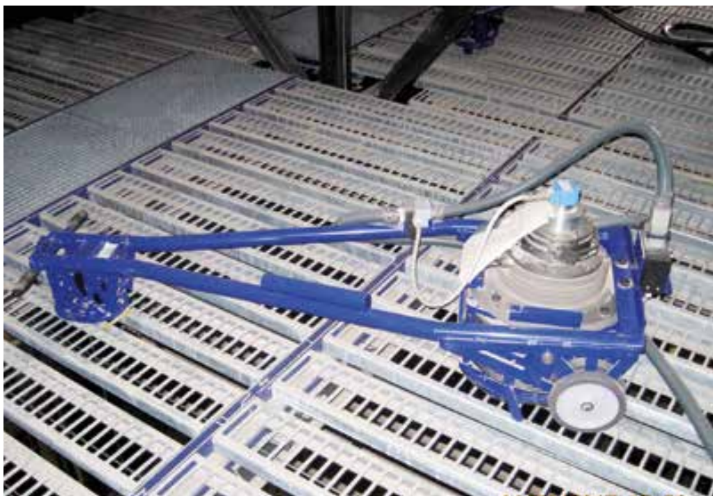
► A kitisztított zsinórpadlásokon több hely van a rugalmas munkához: A mobil ponthúzókat tetszőleges helyen lehet használni.
