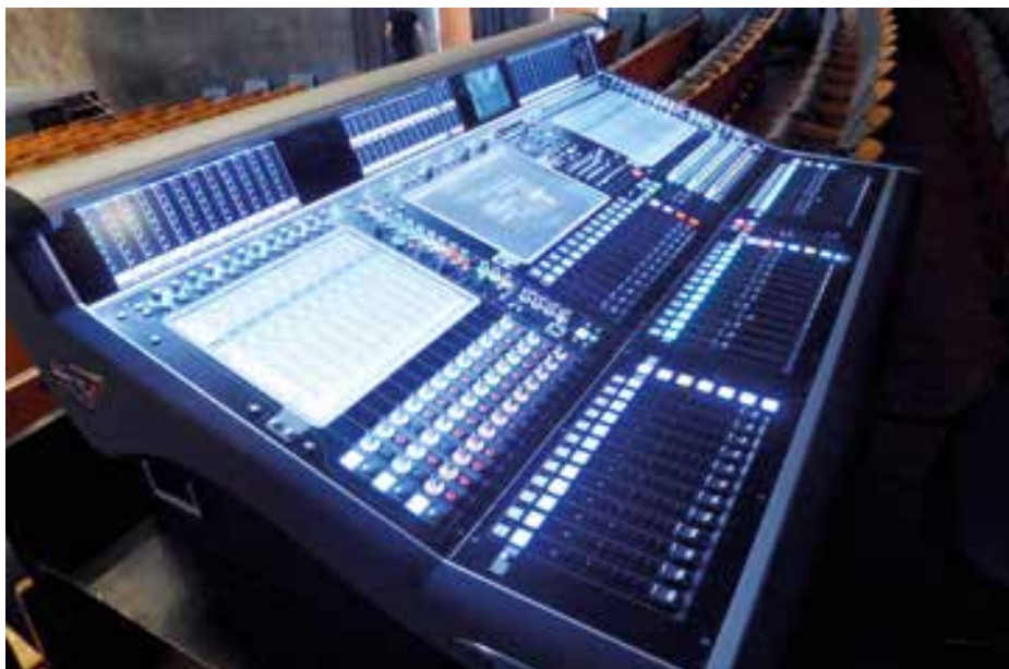
► Digitális hangkeverő pult: egy Digico SD7 a fő pult, SoundGrid-dal, a második keverő pedig egy Digico SD10 pult. Mindkettő rendelkezik Theatre Update rendszerrel.
