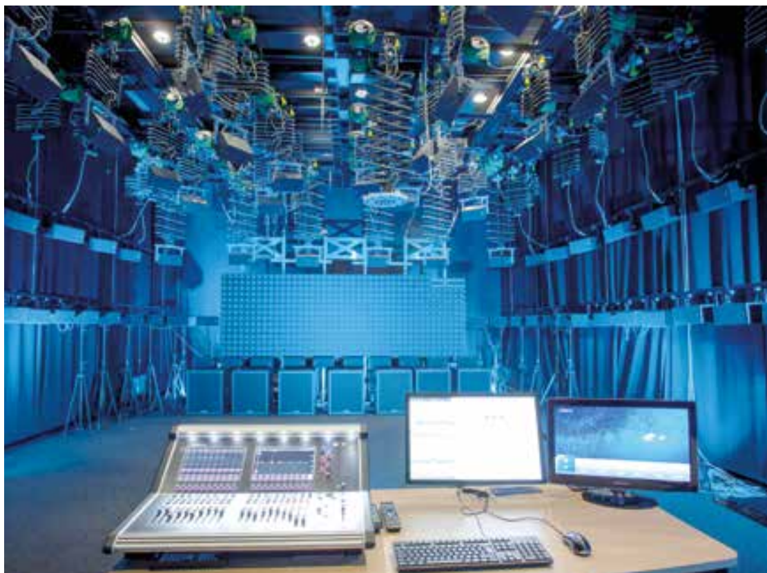
► Fraunhofer Intézet Digitális Médiatechnológia: többnyire ez az intézet fejleszti a térbeli hanghullám (spatial sound-wave) rendszereket. Itt 576 hangszóró látható.
