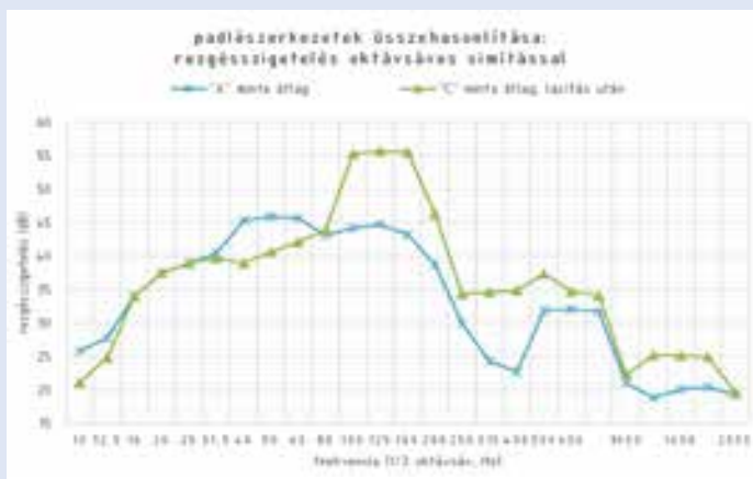
► 5. ábra: A táncpadló-szerkezetminták rezgésszigetelése saját földem felé (gerjesztés kopogógéppel, „A” minta: hagyományos, „C” minta: gumibetétes lengőpadló)
