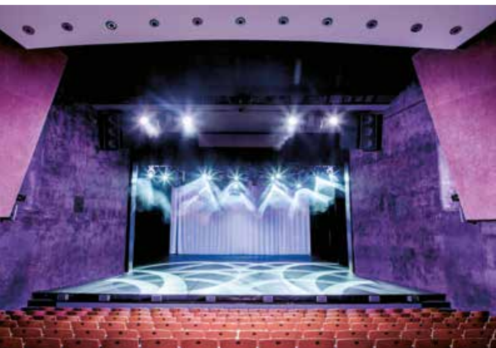
► A nagy színházterem: a színpadgépészet, a színpadvilágítási és az audiovizuális rendszerek felújítása két, egyenként öt hónapos zárva tartás alatt történt. A portálkeret sötét színű, a zenekari árok mellvédjén a közeltéri hangsugárzók az első sorokban ülők jobb hangellátását szolgálják.
