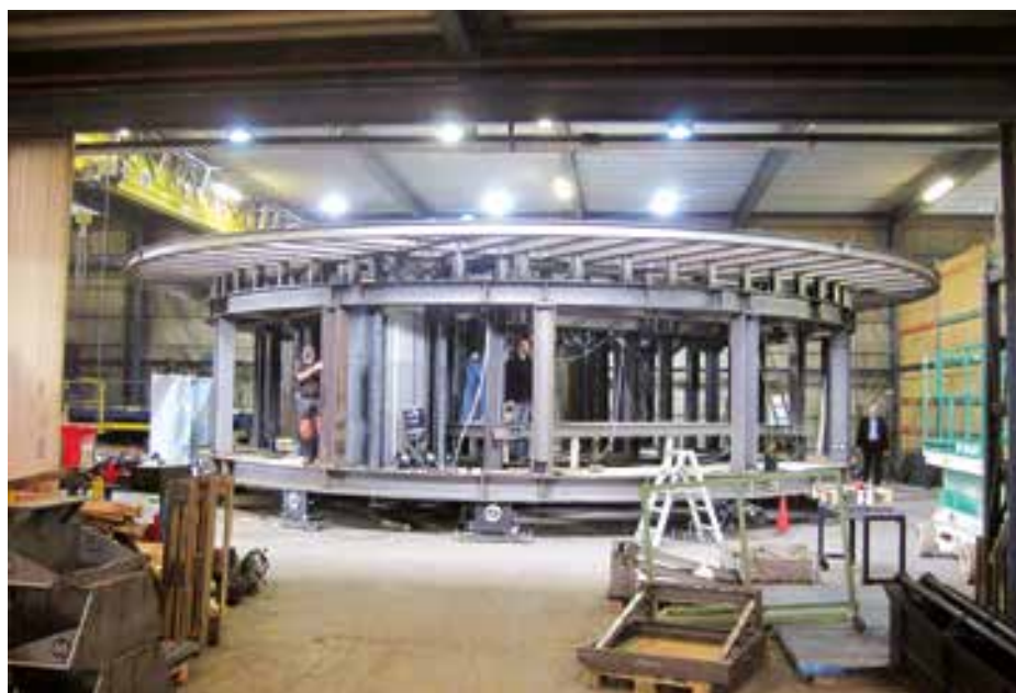
► Az alsószínpad modern szíve: A beépített süllyedőkkel a dobforgó nagy fokú rugalmasságot tesz lehetővé – a fotó a gyári átadáson készült
