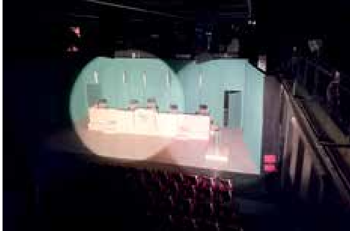
► Balra a LED jobbra a halogén reflektor fényköre látható
