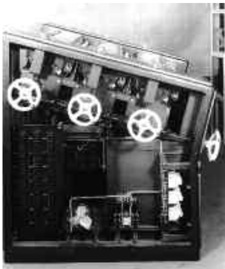
6. ábra. 60 áramkörös, íves szabályozós vezérlőasztal
