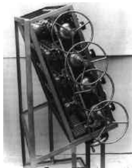
2. ábra. 24 áramkörös, kör-potenciométeres vezérlőegység (hátulnézet)
