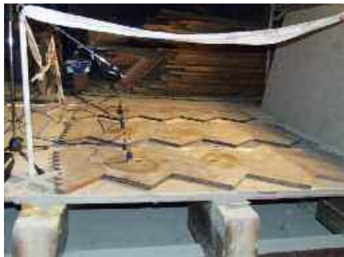
12. ábra: Különféle rögzítésű parkettaminták rezgésakusztikai vizsgálata a Nagyterem nézőtérén
