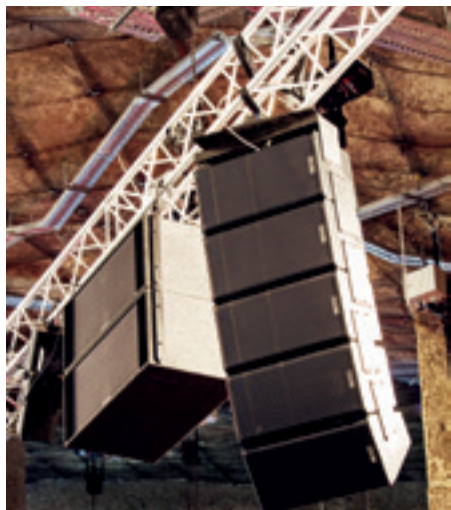
► Line-Array hangsugárzók – a jobb cluster
