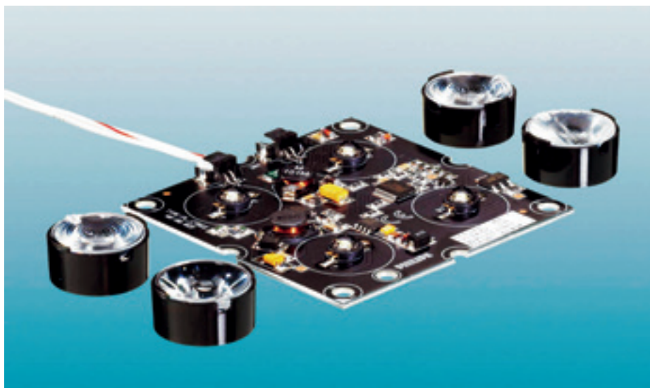
► A színpadvilágítási LED forradalom kezdete – LED-panel és csereoptikák 2006-ból
