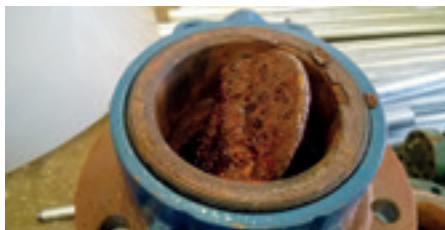
▶ 1. Elrozsásodott szelepek (az idő vasfoga)
