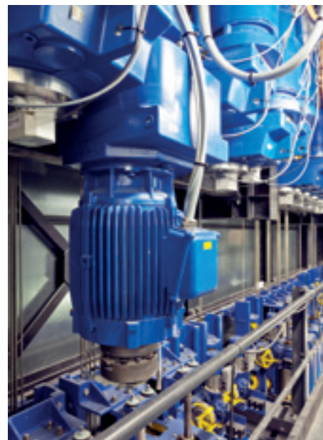
► Gépi díszlethúzó gépegyeség
