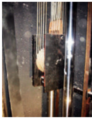
► Hidraulikus hengerrel működött díszlethúzó, csigaáttétellel
