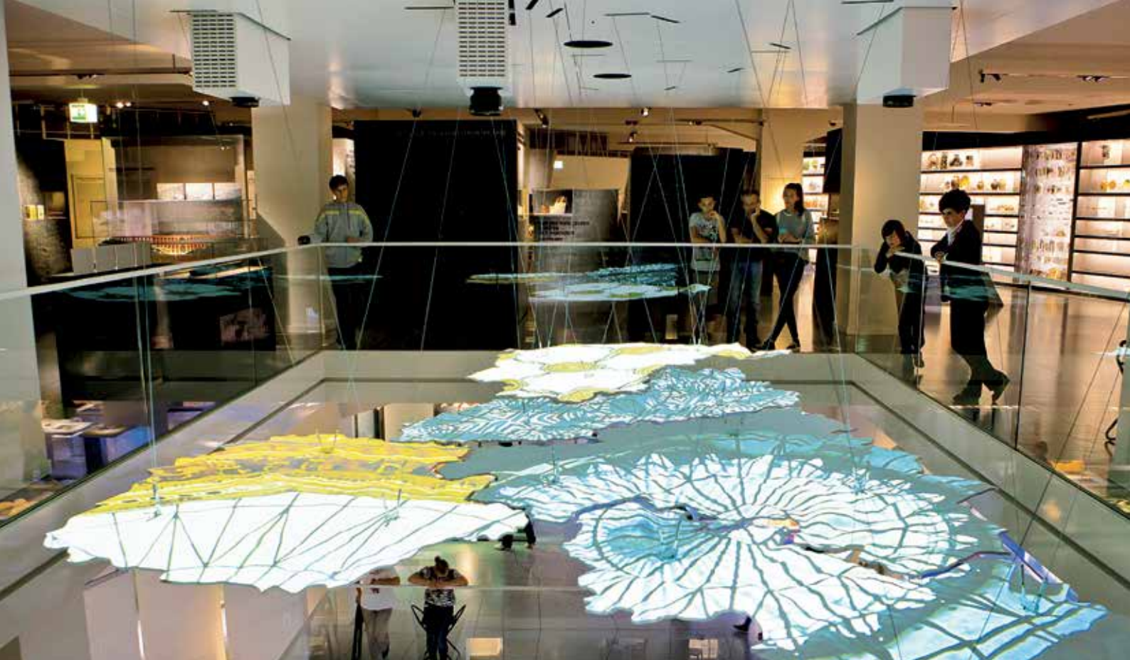
► Kinetikus tájmodell: a vetítési felületeket 30 acélkábel tartja. Mozgásukat a mintegy 15 méter magas, három kiállítási szintet tartalmazó múzeum légtérében egyedileg vezérelhető szervomotorok segítségével kiviteleztek. Összesen nyolc projektor működik, amelyek közül öt a mennyezetben, egy-egy pedig a másik három emeleten található
