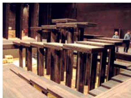
► A 72 db, 1x2 m-es süllyedő a Nemzeti Színház színpadán és a süllyedőket emelő lábak az alsószínpadon
