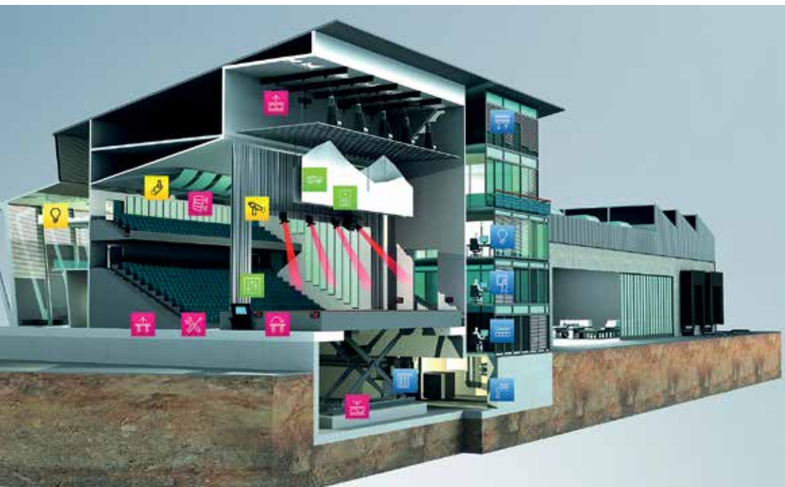
► Automatizálási lehetőségek egy színházban: színpadgépészet, színpad- és általános világítás, AV rendszerek és média-vezérlés, épületfelügyelet integrált vezérléstechnikával
