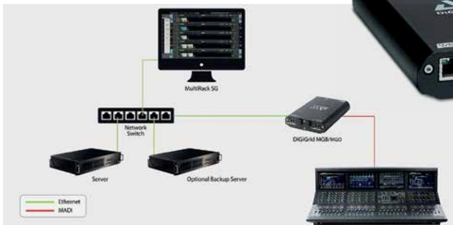
► Felhasználási példa redundáns szerverekkel SG-MADI fordítással
