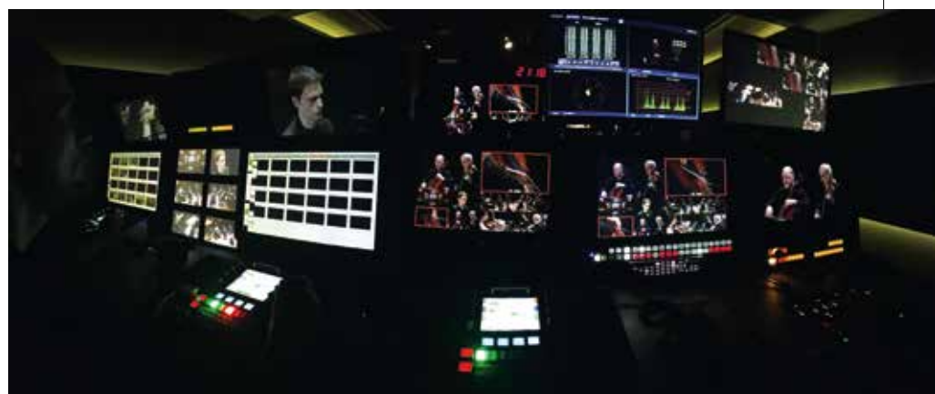
Középen és balra a Telemetrics pan/tilt vezérlők, jobbra a képmérnöki munkahely az RCP panelekkel és a referenciamonitorokkal
