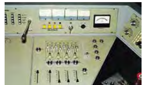
A kombinált vezérlőasztal jobb oldalán helyezkedett el a négyesatornás keverőasztal 12 mikrofonvonallal, visszhangosítóval és rugós zengetővel
