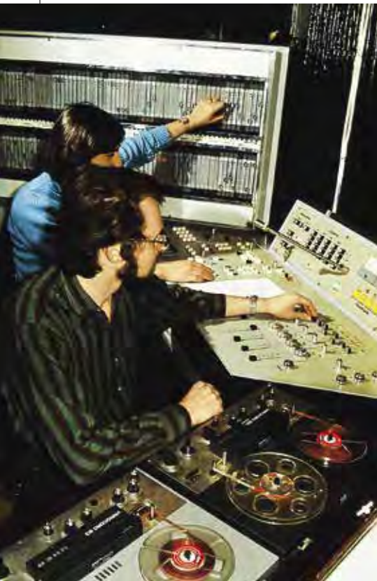
A két kezelő számára kialakított Centolux Star Th-Ela 48/24-4 (RAVISZ) típusú kombinált manuális vezérlőasztal. A begyakorlott műsort már egy ember is levezényelte
