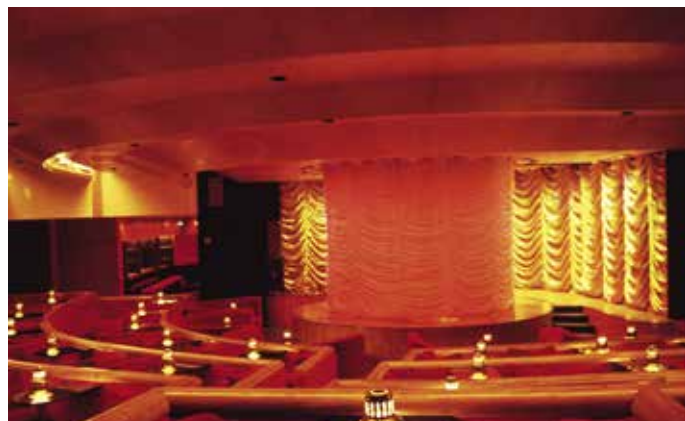
A két oldal- és a középső színpadot arany revüfüggönyök zárták le, a forgószínpad feletti nyílásból leereszthető hengeres felhőfüggönybe a szereplők a színpad felől be tudtak menni
