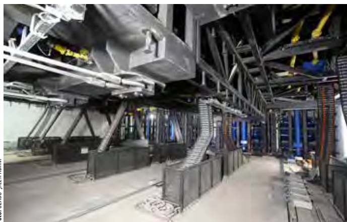
A süllyedőrendszer alsó tere, energialáncokkal
