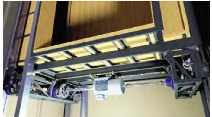
A kabin alja a hajtásegységgel
