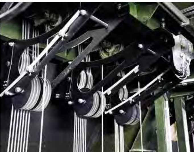
Díszlethúzó súlymérő celláinak kötéltelrelései
