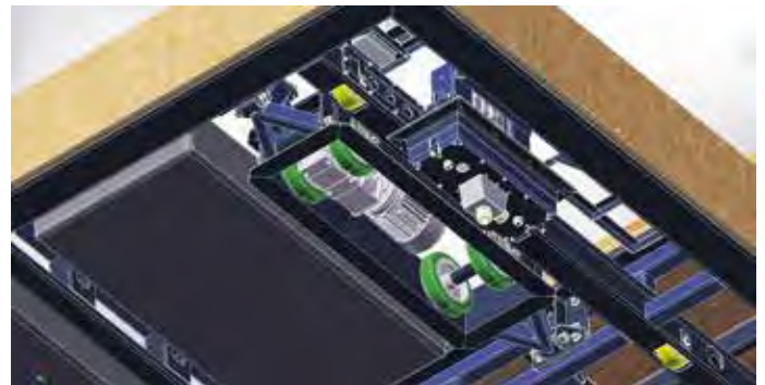
Forgószínpadi kocsik hátsó hajtásegysége és dokkolószekrénye
