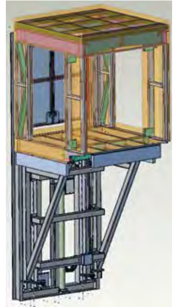
Oldalpódiumok szerkezeti felépítése
