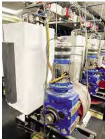
Világítási tartó hajtásegysége villamosszekrénnyel
