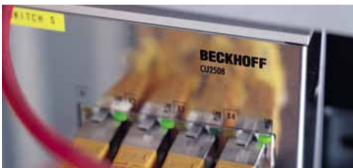
Szerverszekrényben elhelyezett Beckhoff CU2508 Ethernet port-elosztó, ami egyszerűen 8 Ethernet hálózat csatlakozását teszi lehetővé
