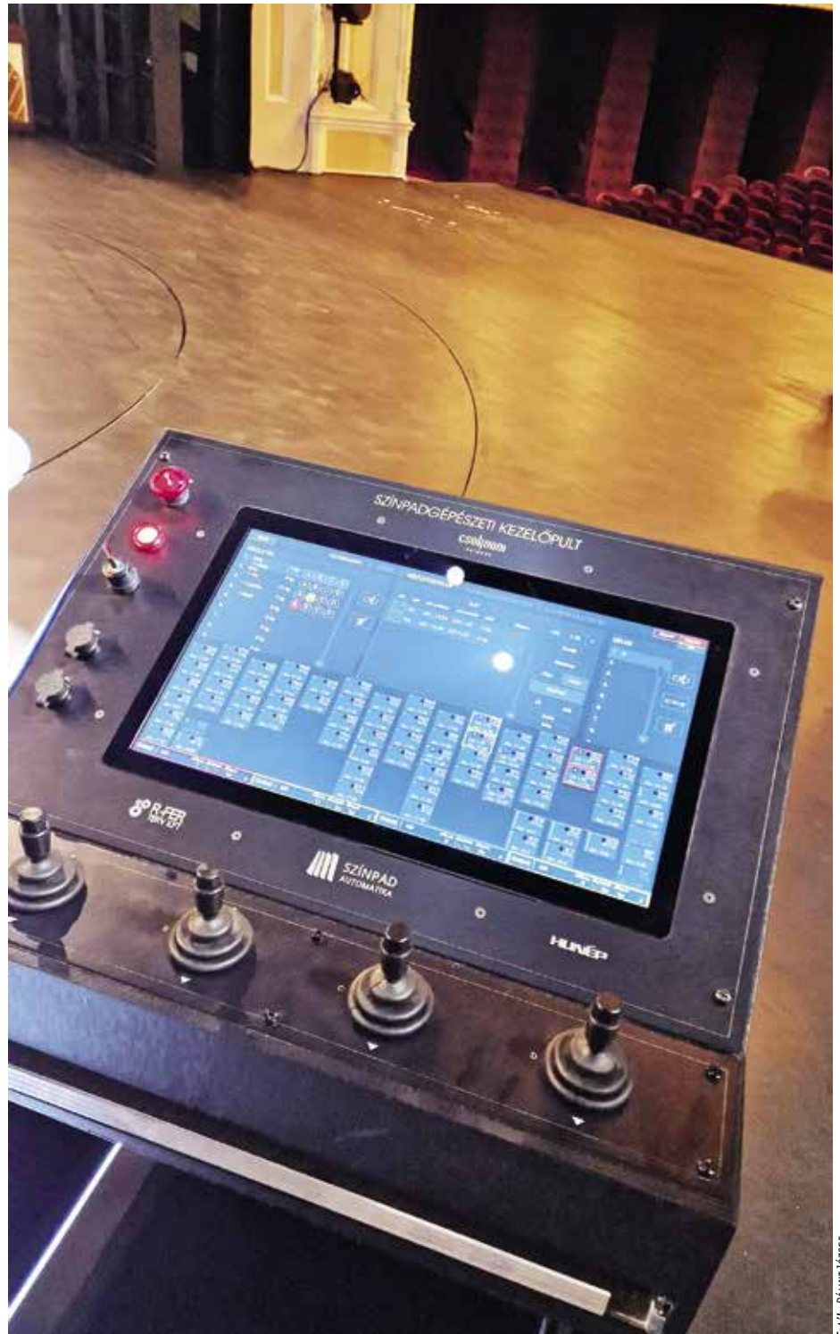
Mobil vezetékes kezelőpult 22 colos kezelőfelülettel
