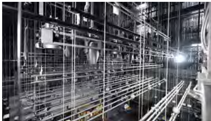
Beckhoff eszközökkel vezérelt, teljes út-idő szinkronban mozgatható díszlethúzó és ponthúzó
