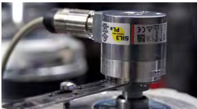
Út-idő szinkron mozgathoz szükséges SIL3 multivalue absolute encoder, Beckhoff feldolgozó-egységgel
