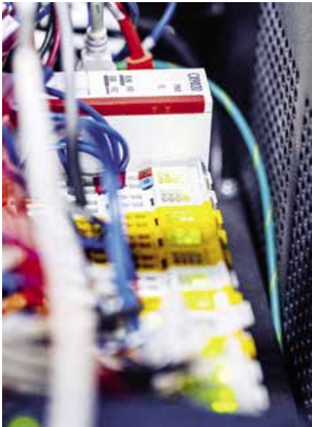
A Flyhouse minden egyes „Kid”-modulja a Beckhoff CX9020 típusú beágyazott PC-jét tartalmazza EtherCAT és TwinSAFE terminálokkal, így használható önállóan vagy más modulokkal együttesen is.
