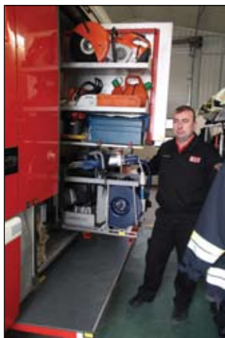
Varnyú Barnabás parancsnok és a legmodernebb Mercedes jármű. A bivalyerős teherutóban víztartály, nagy teljesítményű porral oltó és a műszaki mentéshez nélkülözhetetlen eszközök egyaránt megtalálhatók.
