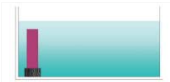
23. ábra: Festett jégtömböt állítunk folytonosan rétegzett sós vízbe. Így egyszerre van jelen sókoncentráció- ill. hőmérsékletgradiens
