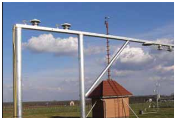
3. kép: A sugárzási egyenleg meghatározására szolgáló mérőrendszer
