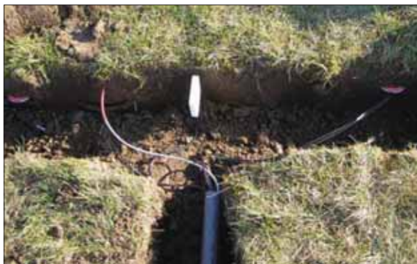
4. kép: Mérőszensorok a talajnedvesség, talajhőáram és talajhőmérséklet mérésére
