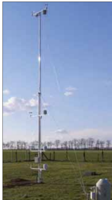
5. kép: 10 méteres mérőtorony a léghőmérséklet, légnedvesség és szélesség gradienseinek meghatározására
