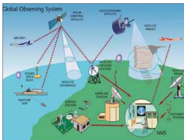
2. ábra: A GOS (Global Observing System) mérőrendszerei
