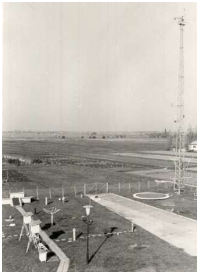
Mérőkert a szarvasi obszervatóriumban, a 30 méteres profilmérő torony lábánál 20 m 2 -es párolgásmérő kád (1974),
