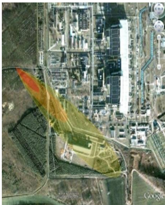
Példa az ALOHA (egyszerű Gauss-típusú modell) alkalmazására: egy feltételezett baleset során 100 kg ammóniát bocsátottunk ki egy perc alatt az atomerőmű bejáratához vezető útszakaszon. Az egyes színek az ammóniára vonatkozó különböző határérték túllépéseket jelentik.
