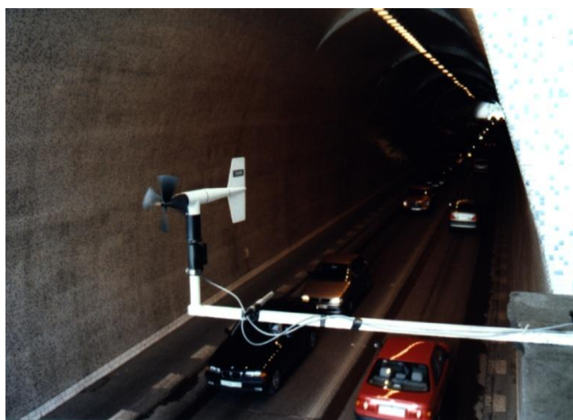
3. ábra: A várhegy alagút szellőzésének mérése levegőminőségi vizsgálatokhoz, 1999 (Salma Imre felvétele).
