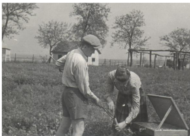
1. ábra: Mikrometeorológiai mérések a Martonvásári Meteorológiai Obszervatóriumban. Szélesség, hőmérséklet és nedvesség profilmérések hagyományos műszerekkel (felül), Erdős László kísérletvezető talajmintát vesz (alul).
