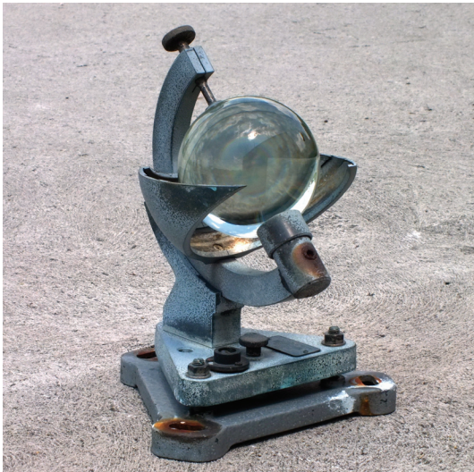
4. ábra FUESS gyártmányú napfénytartammérő
