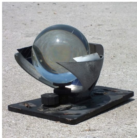
3. ábra: METRA gyártmányú napfénytartammérő
