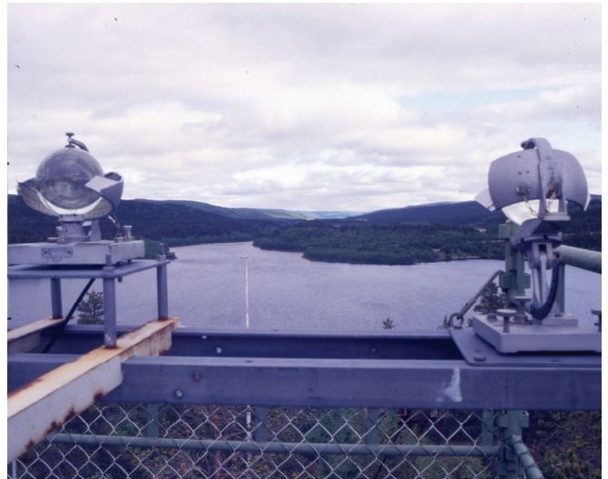
5. ábra: Napfénytartammérők a Sarkkörön készen arra, hogy 24 óra napfénytartamot regisztráljanak
