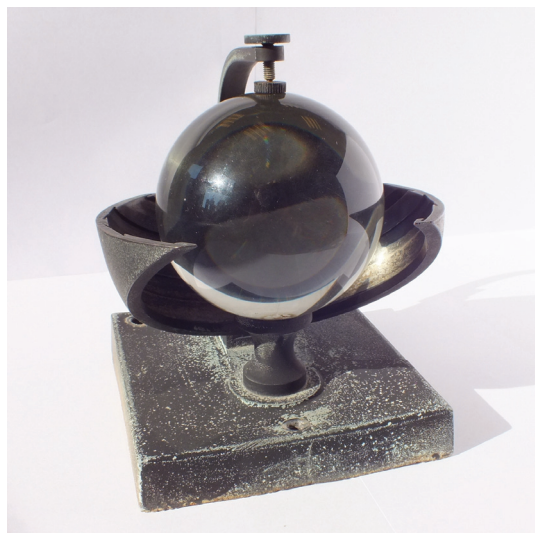
2. ábra: JUNKALOR gyártmányú napfénytartammérő
