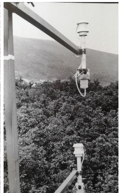
Automata pszichrométer a tornyon
