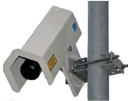
21. ábra: Jenoptik SHM30 lézeres hómagasságmérő
