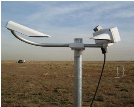
47. ábra: Vaisala PWD22 látástávolságmérő
