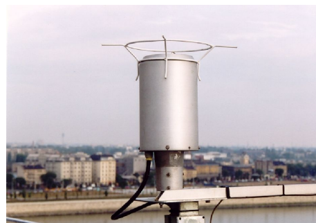
13. ábra: Lambrecht 15188 típusú csapadékmérő
