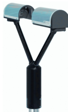
19. ábra: OTT Parsivel cseppspektrum mérő
