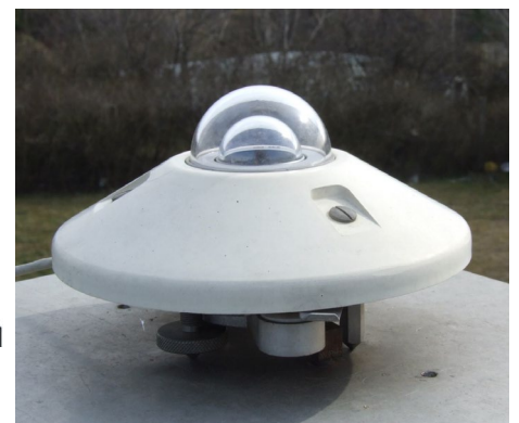
37. ábra: Kipp & Zonen CM 11 sugárzásmérő
