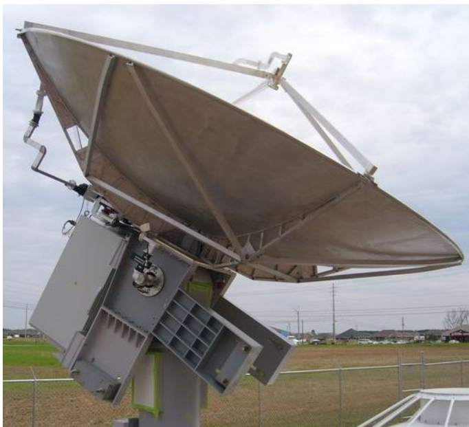
17 ábra: A DWSR 2500C SIDPOL radar antennája
