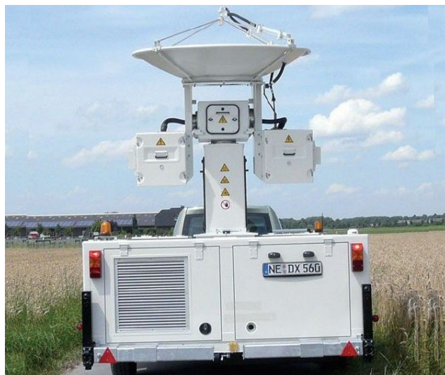
7. ábra: A Pápara telepített Doppler duál-plarizációs SELEX METEOR 60DX mobil mini radar
