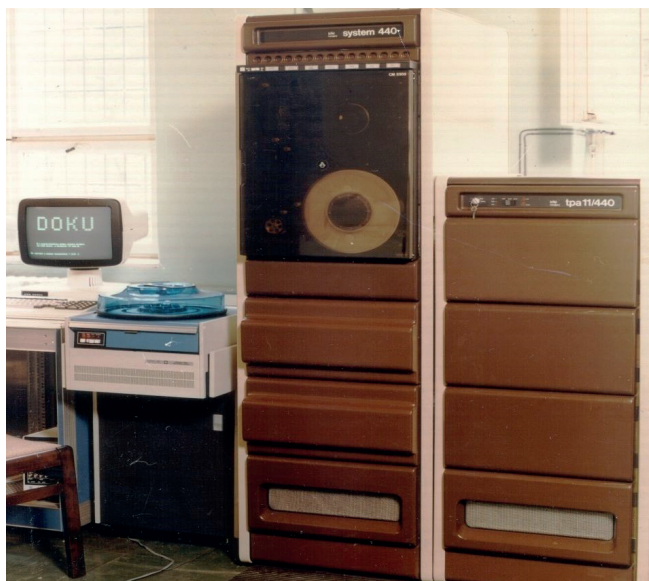
10. ábra: Az éghajlati adatfeldolgozást, archiválást segítette a TPA 11/440 többfelhasználós számítógép
