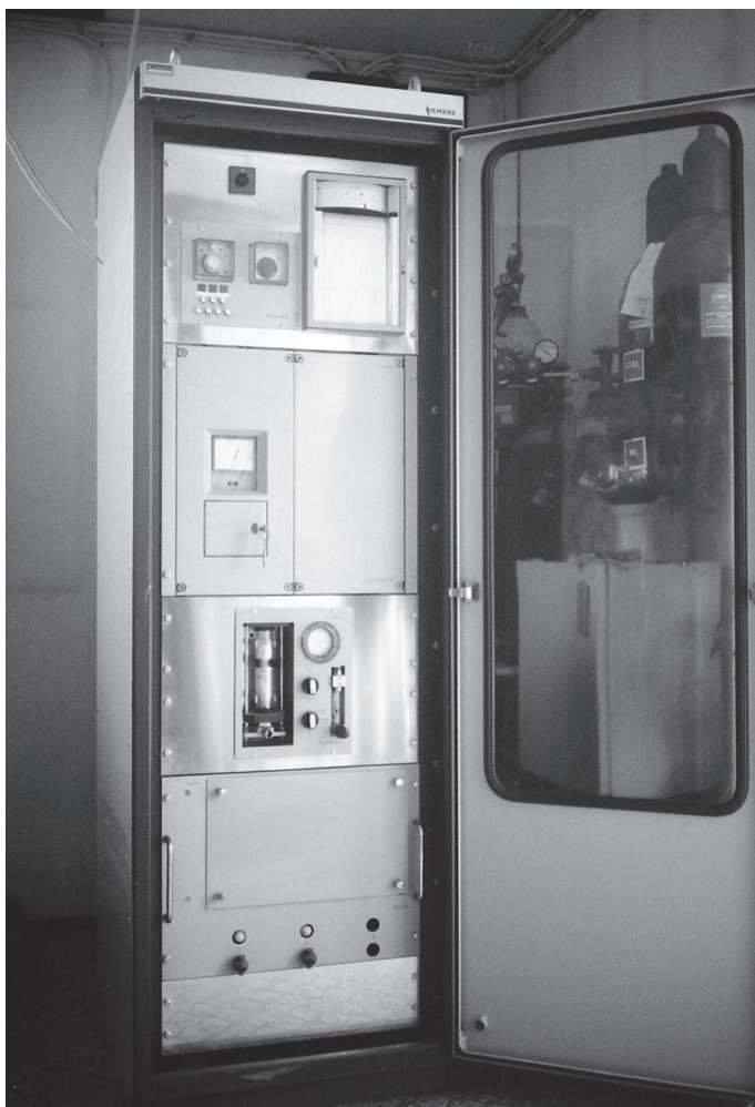
1. ábra: A WMO által adományozott Siemens Ultramat 3 típusú szén-dioxid mérő műszer az OMSZ K-pusztai háttérlevegőszennyezettség-mérő állomásán
