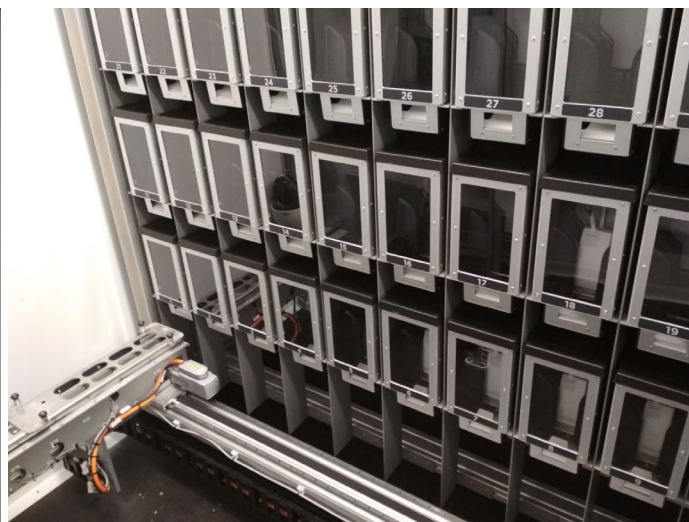
3. ábra. Az autoszándázó rendszer tároló rekeszei a robotika egy részével
