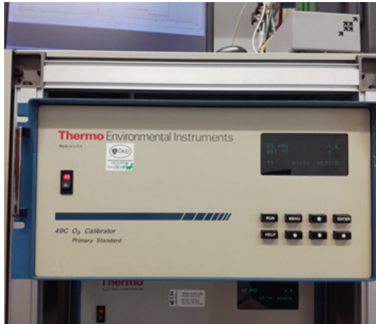
7. ábra. Ózon kalibrátor az LRK laboratóriumában.
