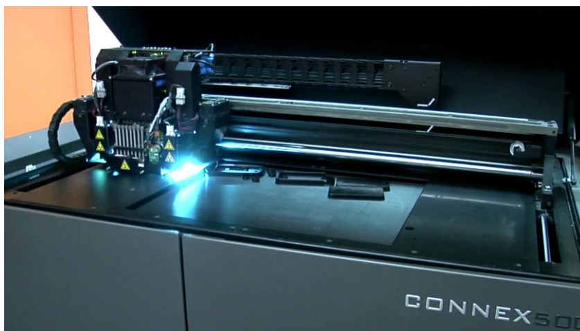
2. ábra Polyjet nyomtató munka közben
