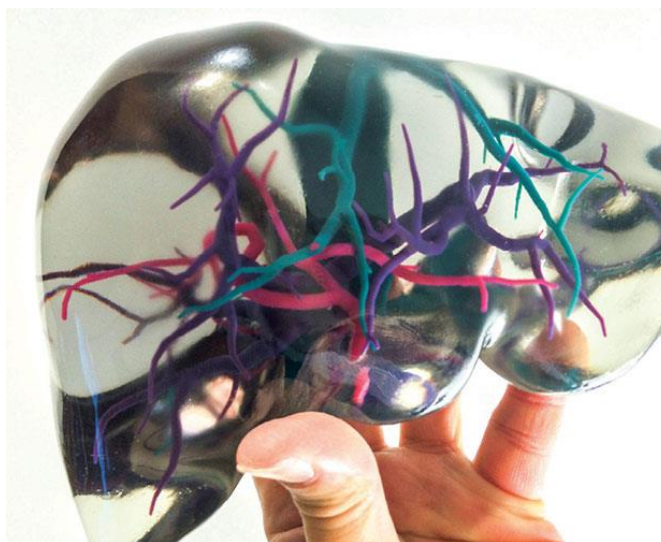
6. ábra Kombinált anyagok nyomtatása Polyjet technológiával
