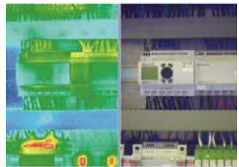
16. ábra Kapcsolószekrény hőkamerás vizsgálata, melegedési pontok keresése (Budaörs, Odvashegyi gépház)
