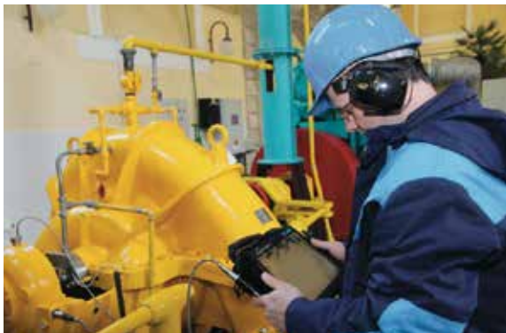
1. ábra Rezgésdiagnosztikai mérés a gyakorlatban (Káposztásmegyeri gépház, Ganz DNR 18 szivattyú és ABB HXR 450LM6 motor)
