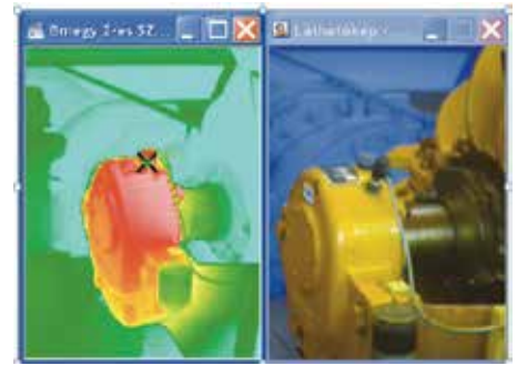
15. ábra Hőkamerás felvétel (Békásmegyeri gépház, WORTINGTON20-LN-26C szivattyú szabad vége)
