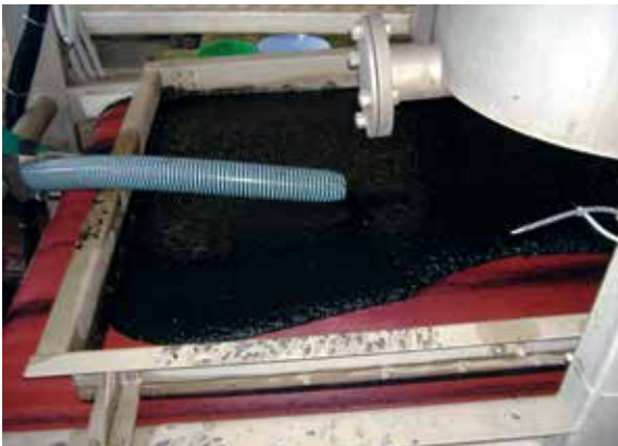
Szennyvíziszap-lignit szuszpenzió feladása vízkiprészeléshez (Gyöngyös)
