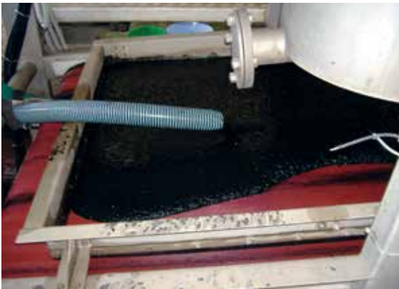
Szennyvíziszap-lignit szuszpenzió feladása vízkipréléshez (Gyöngyös)
