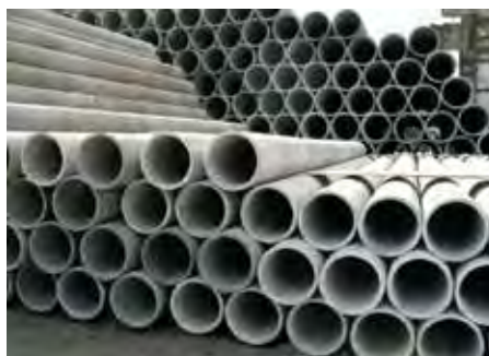
NA 100-as eternitcsövek
