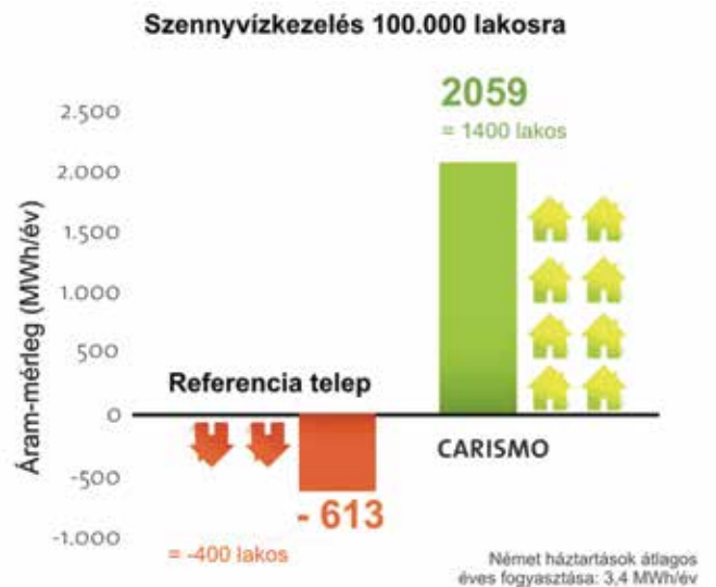
A CARISMO koncepció áramfelhasználásának és biogáz kizozatalának összehasonlítása egy eleven iszapos referenciataleppel
