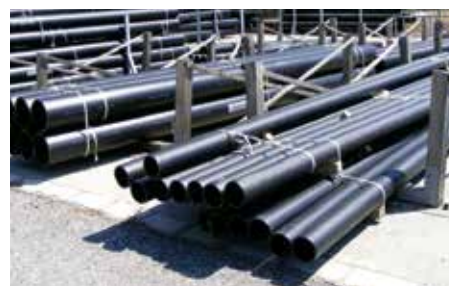
Kiszállításra váró KPE nyomócsövek
