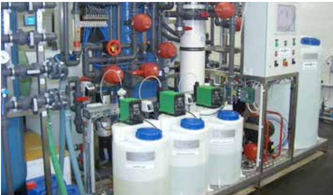
Ultraszűrő pilot berendezés a miskolctapolcai vízműben
