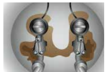
3. kép: Kiülepedések a TOP 100-as átemelőaknában. A megmaradó szilárd összetevők a szivattyúk szívónyílása közelében gyűlnek össze.
