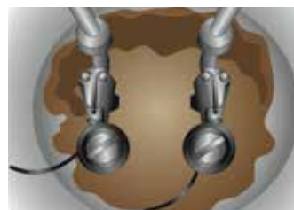
2. kép: Kirakódások a hagyományos, 1600 mm-es átemelő aknában. A kiülepedések a teljes aknafenek mentén kialakulnak.
