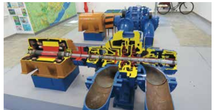
A régi szivattyú belülről
