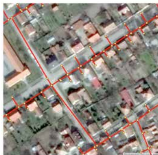
Hálózat megjelenítése térinformatikai programban, bekötési vízmérőig tartó részletességű modell
