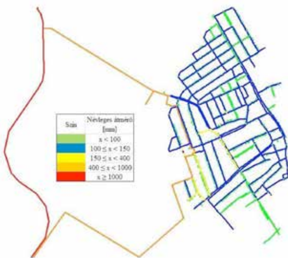
Hálózat megjelenítése térinformatikai programban, bekötési vízmérőig tartó részletességű modell
