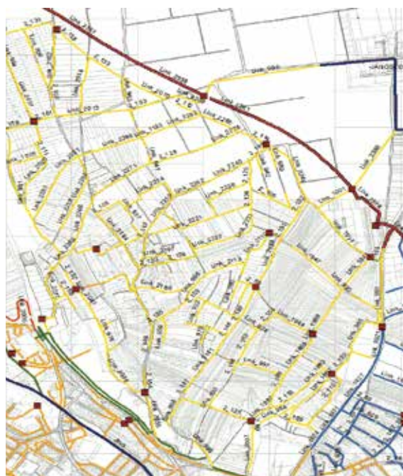
4. ábra: Virág völgy - javasolt csatornahálózat-kialakítás (új hálózat és tározók)
