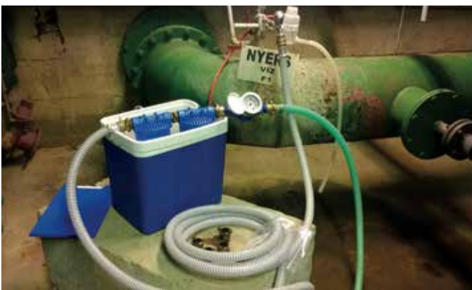
2/b ábra: A bejövő víz mintázása a VCSM Zrt.-nél
